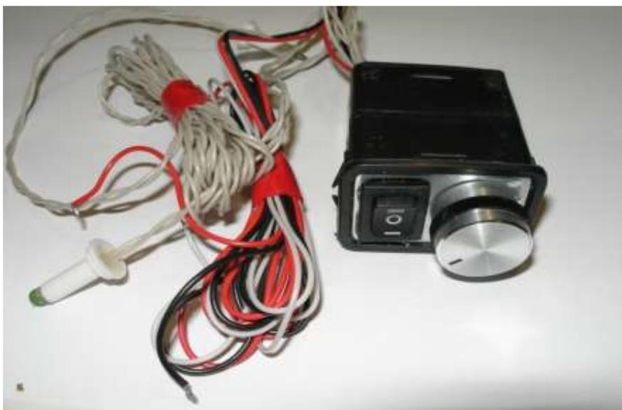
Рисунок 4 – Автоматический регулятор частоты вращения вентилятора отопителя
