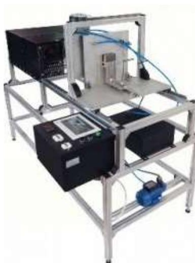
Рисунок 3 - Стенд для испытаний материала и пакетов материалов, подвергаемых воздействию источника теплового излучения компании Clever Lab
