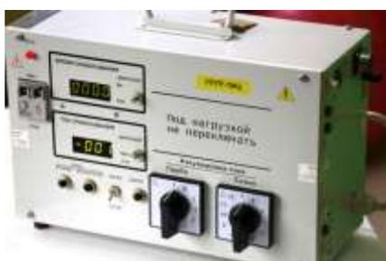
Рисунок 1 - Установка испытания автоматических выключателей УПТР-1МЦ
