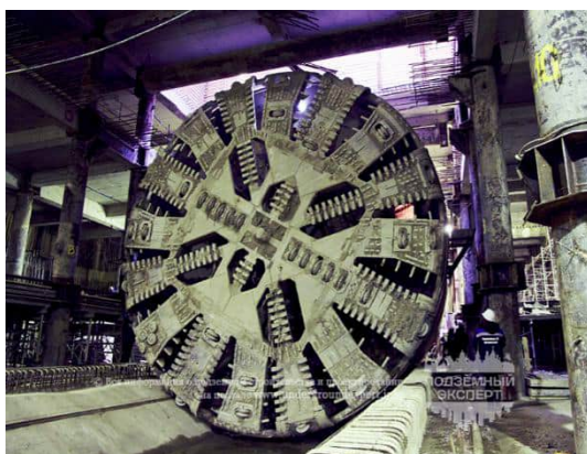
Рисунок 3 - Щит для проходки перегонных однопутных тоннелей диаметром 5,63 метра
