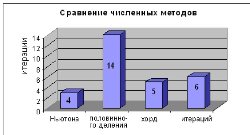
Рисунок 4 – Сравнение численных методов на интервале [-5;-3,9]
