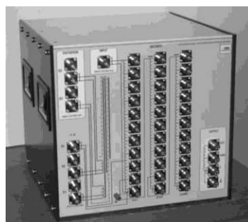
Рисунок 2- Индуктивный делитель до 1000 В
