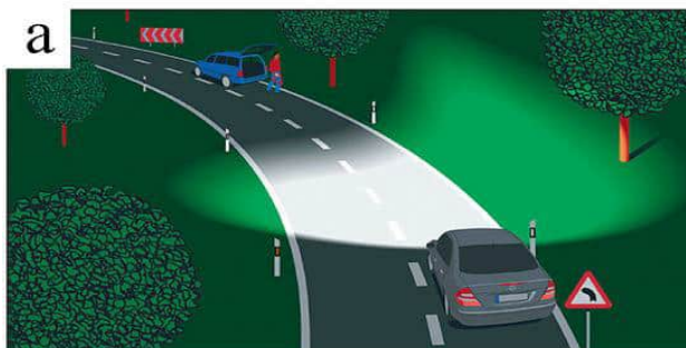
Рисунок 3 - Освещение дороги фарами ближнего света:
