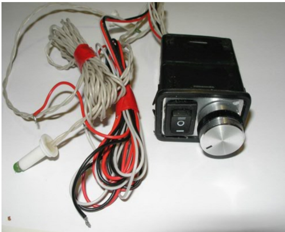
Рисунок 5 – Автоматический регулятор частоты вращения вентилятора отопителя
