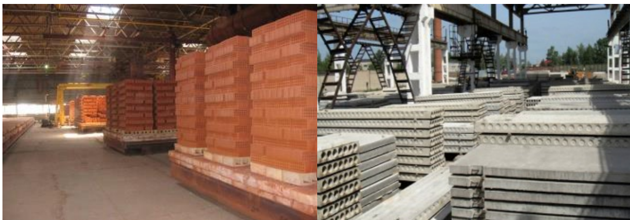
Рисунок 5 - Хранение железобетонных конструкций и кирпича
