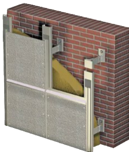
Рисунок 1 – Устройство вентилируемого фасада
