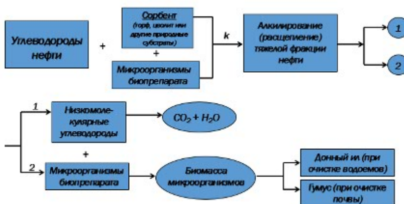
Рисунок 1 – Принцип действия биопрепаратов
