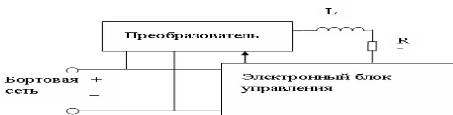
Рисунок 2. Подключение форсунки к бортовой сети через преобразователь параметров электрической энергии.
