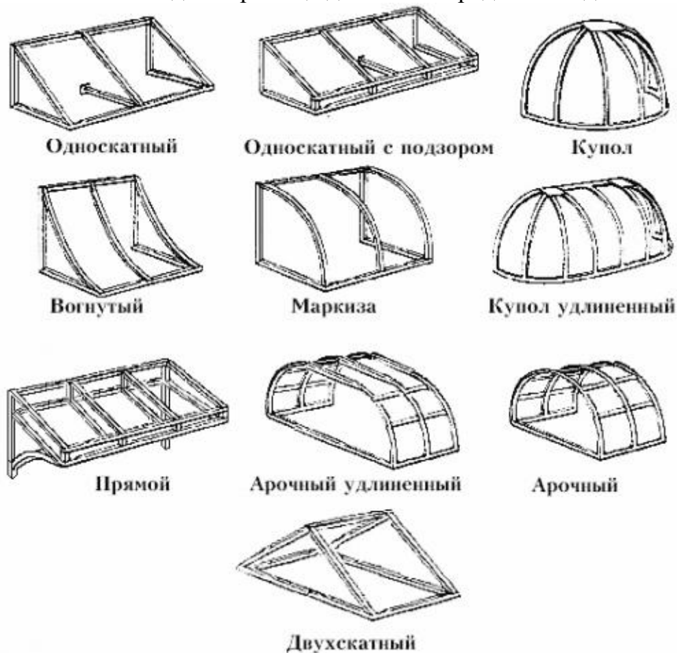
Рисунок 4 - Варианты конструкций козырьков над крыльцом
