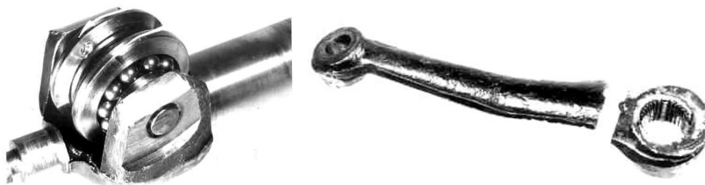
Рисунок 1 – Повреждения поверхности ролика и разрушение сошки рулевого механизма
