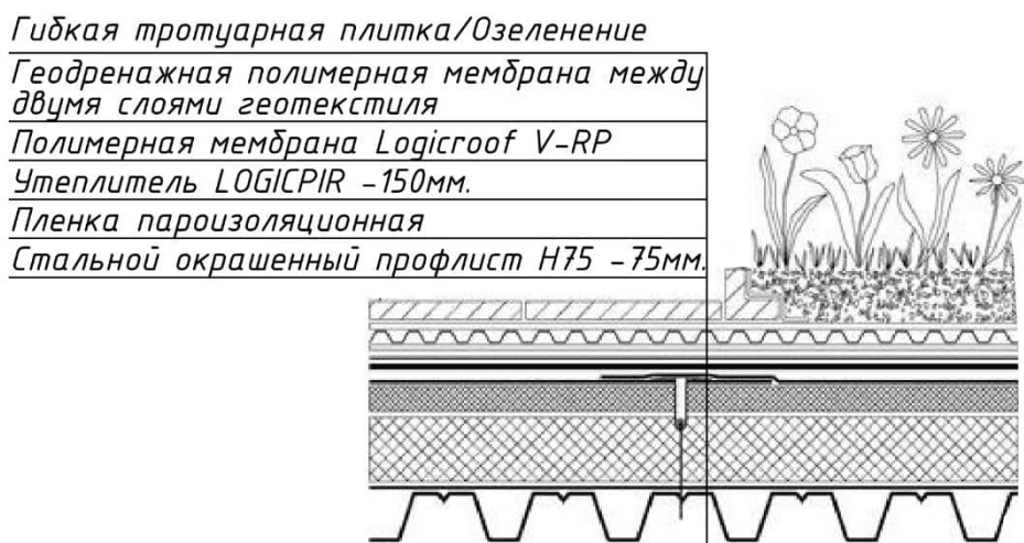
Рисунок 5 – Пирог покрытия плоской эксплуатируемой кровли
