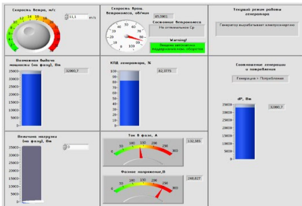
Рисунок 2 - Внешний вид лицевой панели виртуального прибора модели ветрогенератора при скорости ветра от 11 до 25 м/с
