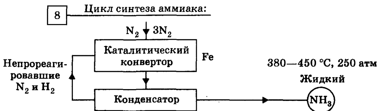
Рис. 20.2. Стадии промышленного процесса получения аммиака
